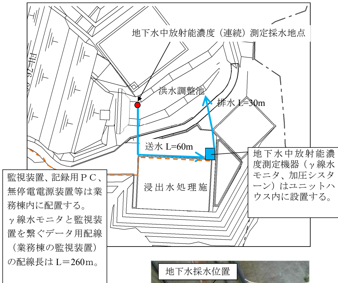
図2 地下水中放射能濃度（連続）測定地点（採水地点、機器の設置場所）
