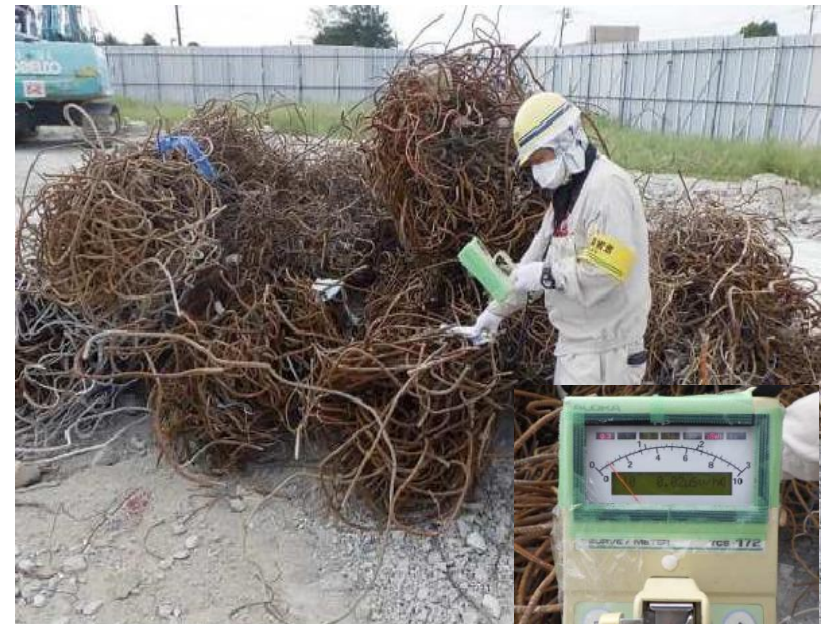
金属くず表面線量率測定状況
