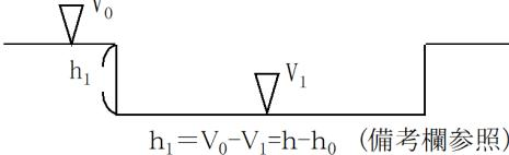
$h_1 = V_0 - V_1 = h - h_0 \quad (\text{備考欄参照})$ | 深さ<br>$h_1$ | $\pm 20\%$ | 丁張り(トンボ)等の設置箇所数は500mに1か所以上設置すること。<br>(施工面積が500m <sup>2</sup> 以下の場合でも最低2か所設置すること。) |     |
