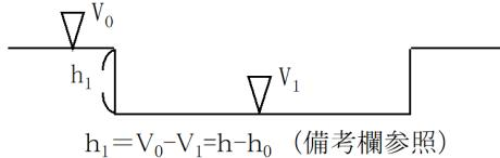
$h_1 = V_0 - V_1 = h - h_0 \quad (\text{備考欄参照})$   | 深さ<br>$h_1$ | ±20% | 丁張り(トンボ)等の設置箇所数は500m <sup>2</sup> に1か所以上設置すること。(施工面積が500m <sup>2</sup> 以下の場合でも最低2か所設置すること。)                                                                                                |
