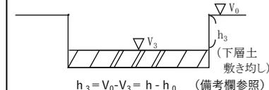
$h_3 = V_0 - V_3 = h - h_0$ (備考欄参照)      | 深さ<br>$h_3$ | ±20% | 丁張り (トンボ) 等の設置箇所数は500㎡に1か所以上設置すること。<br>(施工面積が500㎡以下の場合でも最低2か所設置すること。)                                                                                   |
