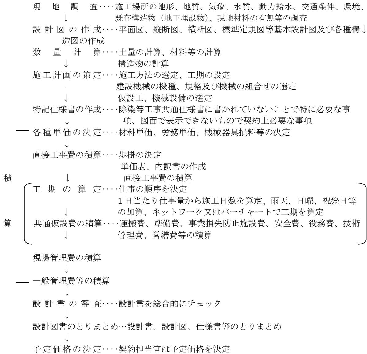
これらは一連の流れであるが、特にその中心となる直接工事費の積算に当たっては、流れを構成する各項目が相互に密接に関係している。たとえば、現場の施工条件などは、工事費の積算に大きく影響するものであり、設計工事費を左右するものである。
